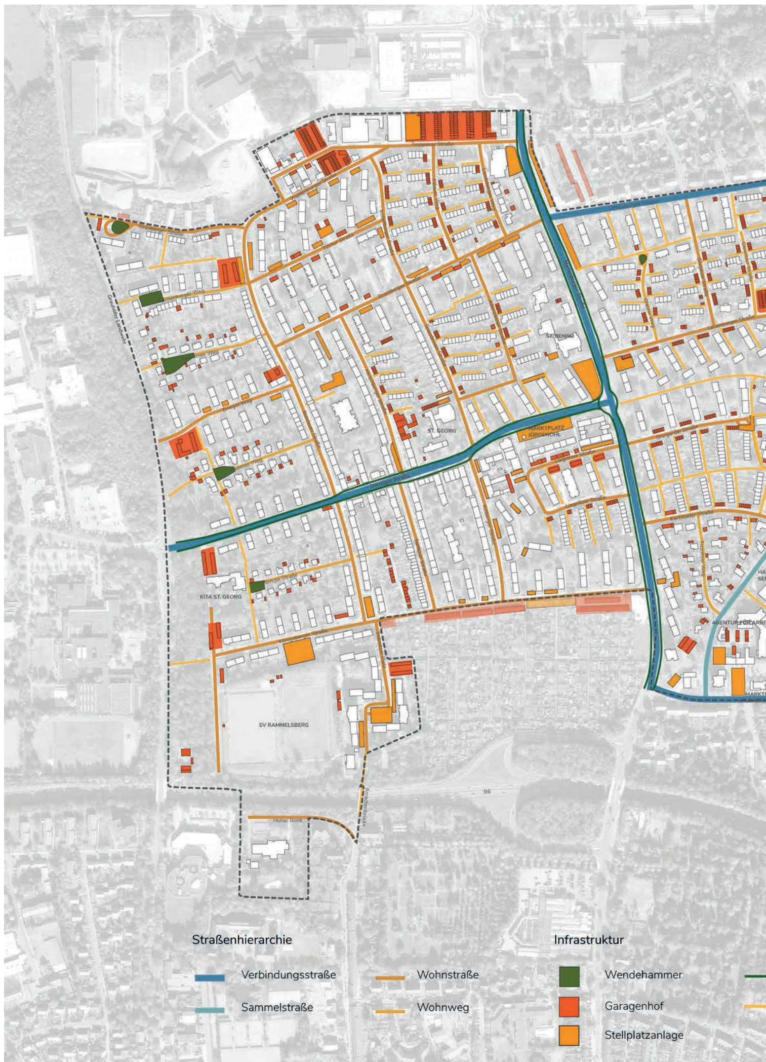
Abb. 23: Analysegrafik Verkehrsräume im Sanierungsgebiet
