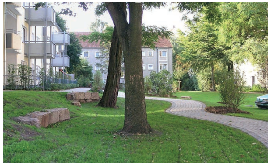
Abb. 75: Barrierefreier Erschließungsweg mit weniger als 3% Gefälle
