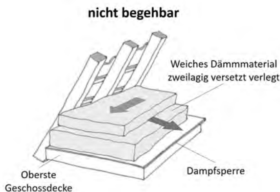
Bild 47 Nicht begehbare Dämmung
